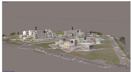
圖 10 混合不同拍攝航高影像建置之三維數值模型。
